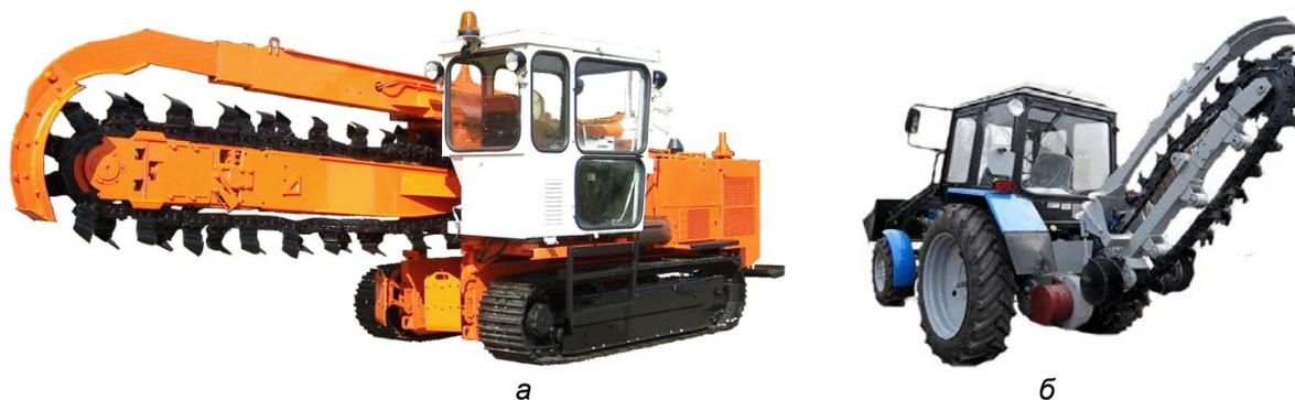
Рис. 3. Экскаватор траншейный цепной: а – ЭТЦ–250; б – ЭТЦ–1609
