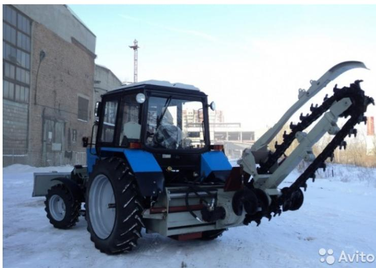
Рис. 4. Экскаватор траншейный цепной ЭТЦ–1609 ГС
