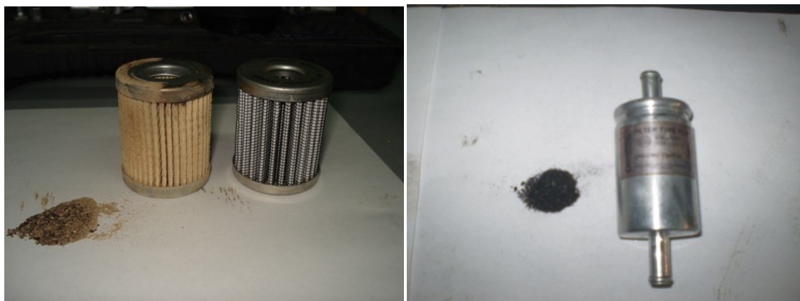
Рис. 4. Загрязнения фильтров системы подачи газа
