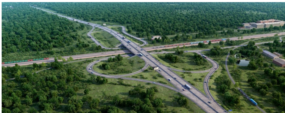
Рис. 1. 3D модель транспортной развязки автомобильной и железной дороги
