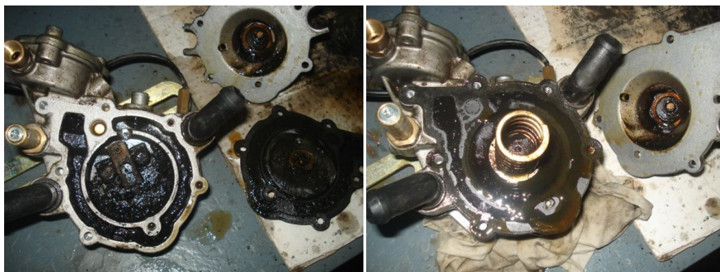
Рис. 3. Состояние внутренних полостей и резинотехнических изделий газового редуктора-испарителя
