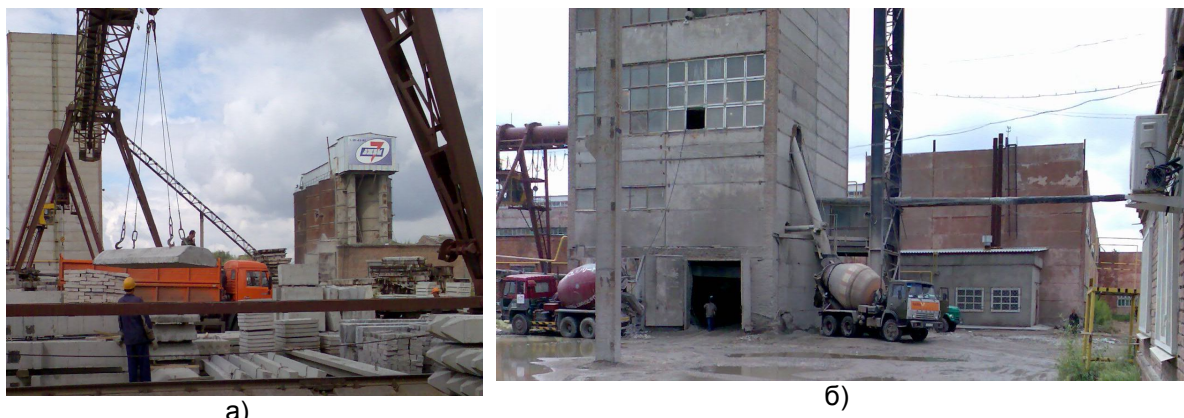
Рисунок 2. – Погрузка на ООО «ЗЖБИ-7» [2]: а – автопоезда; б – автобетоносмесителей
