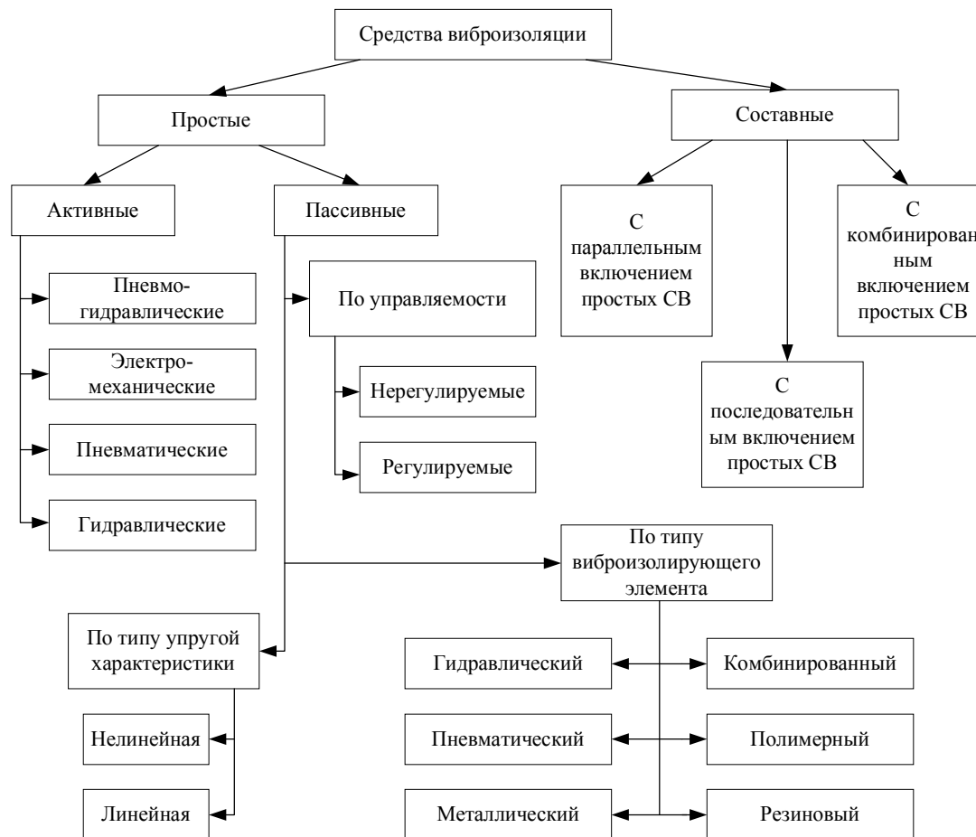
Рисунок 2 - Классификация средств виброизоляции
