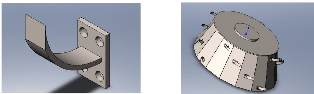
Рисунок 3 – Трехмерная модель: справа – детали «Сборка - Нож» Слева – детали «Ротор»
