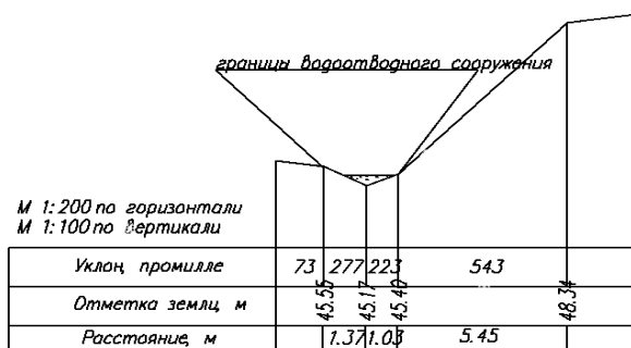
Рисунок 5 - Поперечный профиль в сечении ПК 0+42
