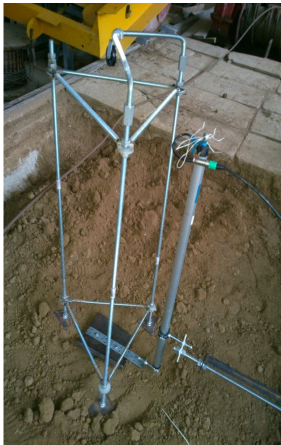
а) Установка при проведении эксперимента с плоским штампом б) Установка со штампом в форме участка цилиндрической поверхности
