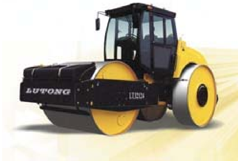
Рисунок 1.1 Гладковальцовый статический дорожный каток
