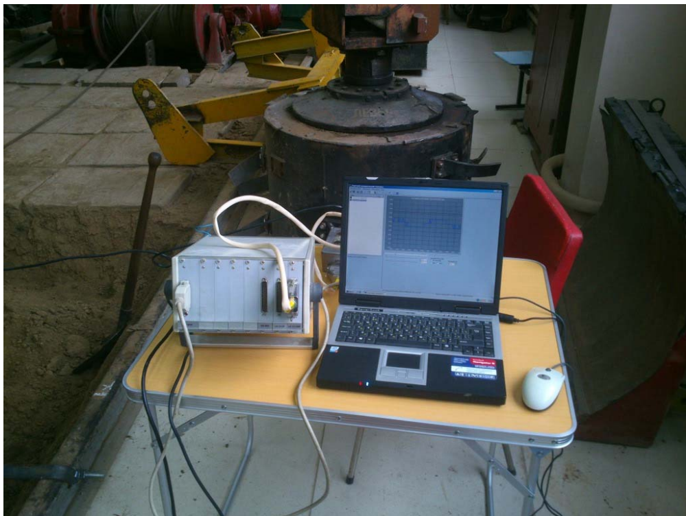
Рисунок 4.3 – Рабочее место оператора установки с готовым к работе БИК
