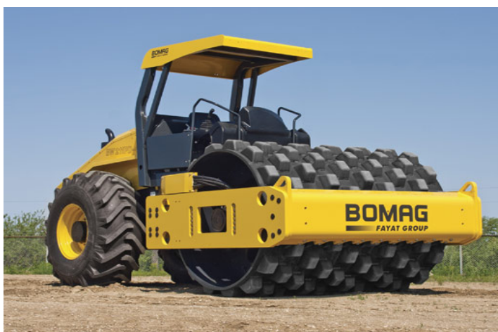
Рисунок 1.3 – Кулачковый статический дорожный каток
