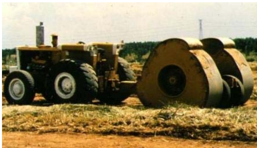
Рисунок 1.8. – Импульсная уплотняющая машина с рабочим органом специального вида.
