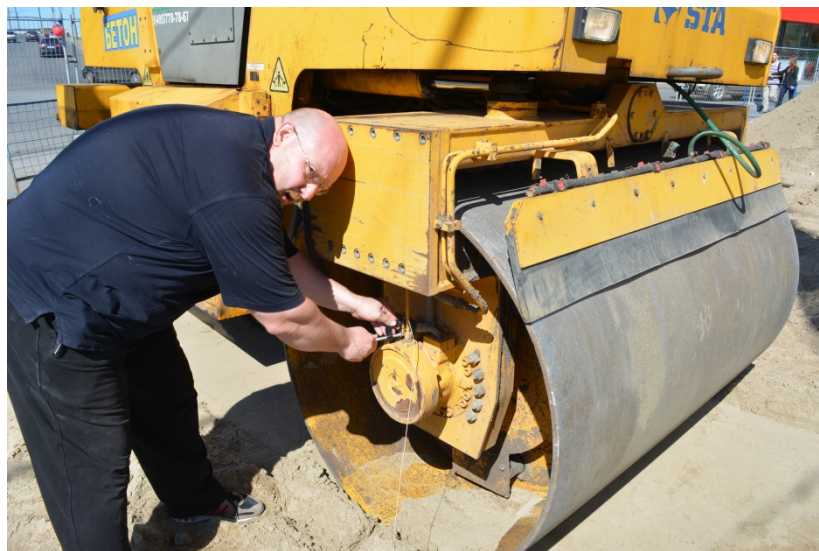
Рисунок 4.15 – Установка датчика измерительного комплекса ZETLAB 017-U8 на оси катка
