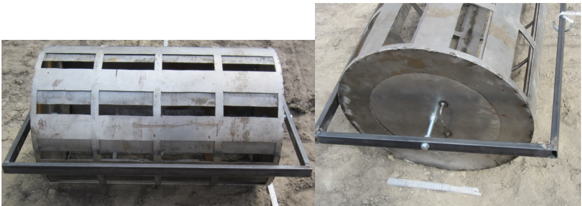
Рисунок 6.8 – Валец специального вида с возможностью адаптивирования контактного давления
