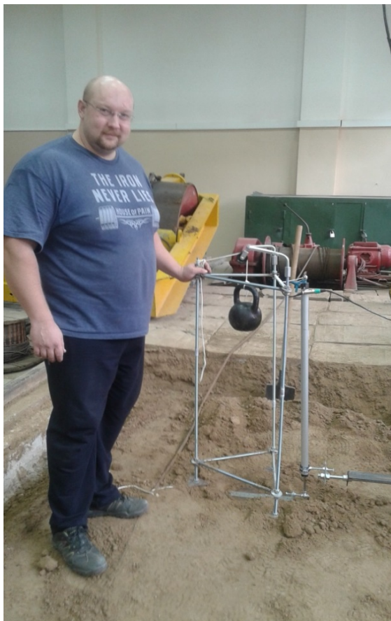
а) Установка при проведении эксперимента с плоским штампом б) Установка со штампом в форме участка цилиндрической поверхности
