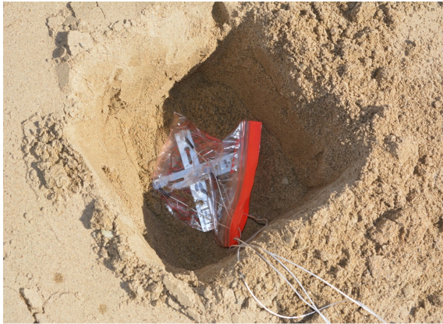
Рисунок 4.14 – Установка датчиков измерительного комплекса ZETLAB 017-U8 в грунтовом слое.
