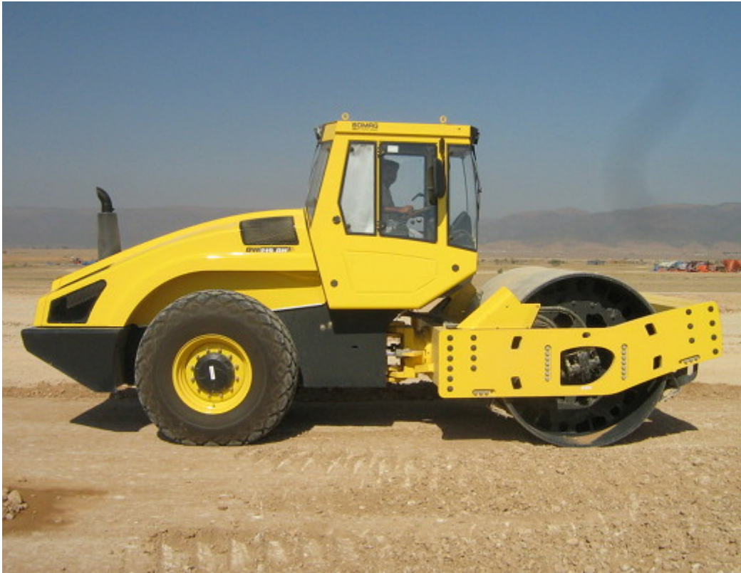
Рисунок 1.6 – Самоходный вибрационный каток
