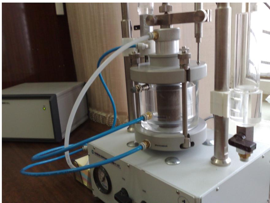
Рис. 1. Общий вид испытания грунтового образца в камере трехосного сжатия
