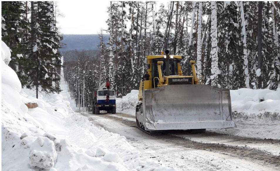
Рисунок 7 – Движение техники при подъёме на обледенелых склонах осуществляется при помощи тракторной техники
