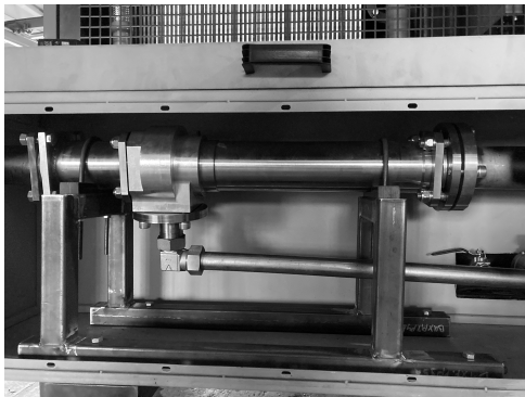
Рис. 12: Фотография промышленного образца вихревой трубы РЕСШ.4414.
