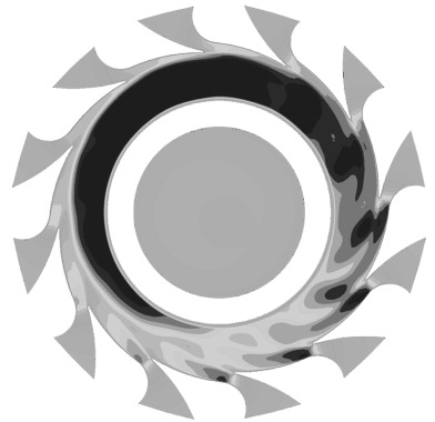
Рис. 10: Распределение числа Ma = |V|/a в проточной части двухкантовой вихревой трубы при возникновении эффекта дестабилизации течения.
